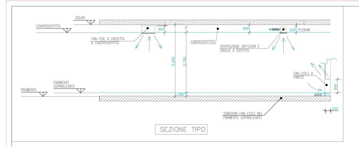
I CANALI PER L'ARIA PRIMARIA SARANNO REALIZZATI IN LAMIERA D'ACCIAIO ZINCATO COMPLETI DI RACCORDI E PEZZI SPECIALI, ISOLATI ESTERNAMENTE. IL COLLEGAMENTO DELLE BOCCHETTE DI IMMISSIONE ED ESTRAZIONE DELL'ARIA IN AMBIENTE SARA' REALIZZATO CON FLESSIBILI PREISOLATI.
